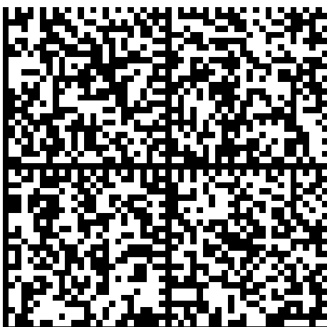
Matrix 52x52, Kapazität: 408 Ziffern, 304 alphanumerische Zeichen, 202 Bytes Größte Matrix mit 4 Segmenten
